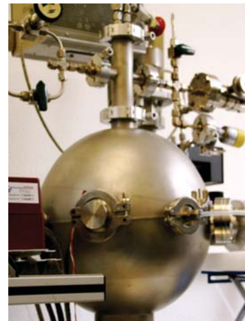
Figura 4 - Câmara de calibração de vacuómetros em conformidade com a ISO 3567:2005
