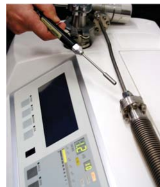
Figura 3 - Localização de fugas com sniffer. O gás sinalizador que sai pela fuga é facilmente identificado pelo detector.
