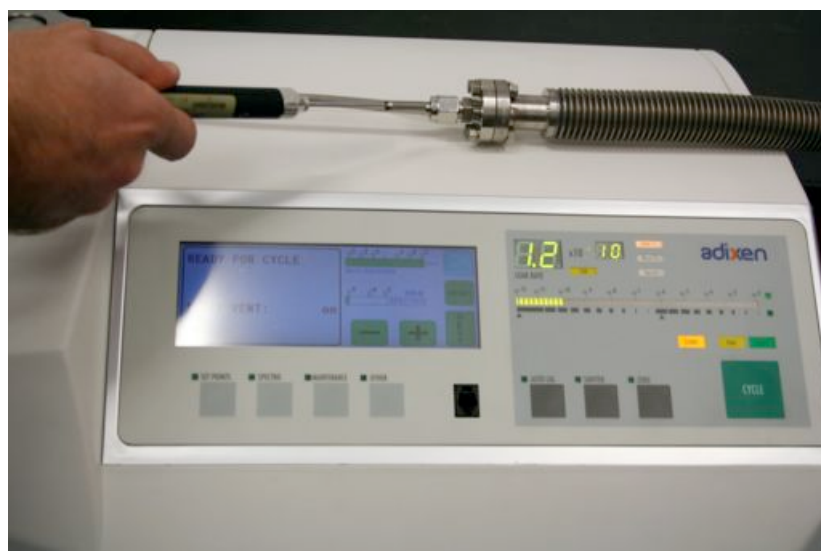
Figura 2— Detector de fugas por espectrometria de massa a hélio
